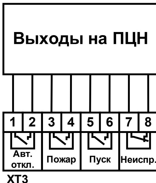
Рисунок 39 – Контакты для подключения выходов на ПЦН.
