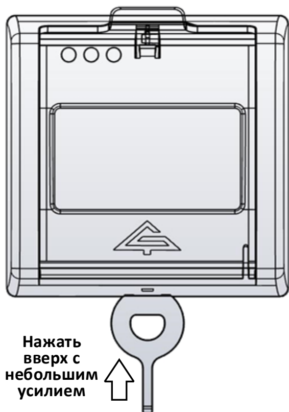
Снятие корпуса ИПР-И, УДП-И.
