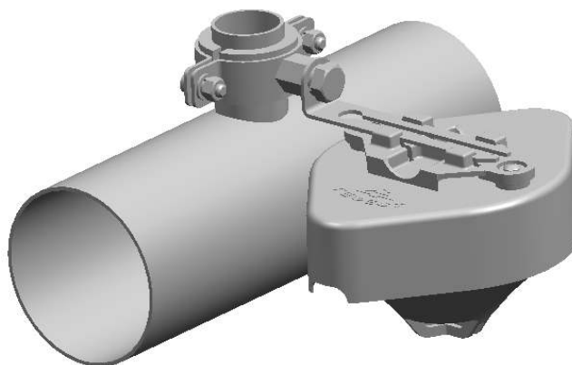
Рисунок 123 – Пример установки ИПТ-СИ-л и МКС-И-л на кронштейн.
